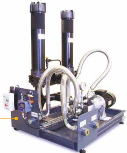
Sistema de filtración de depósito de almacenamiento a granel con ICM y caja de control
