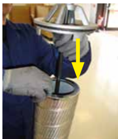
Insérer le support dans l'élément filtrant
