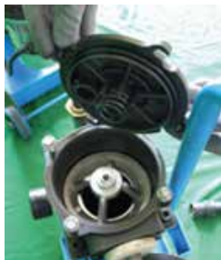
Vérifier le positionnement du filtre et de son support puis remettre le couvercle
