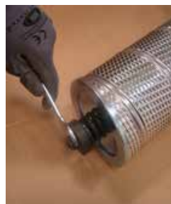
Serrer l'écrou jusqu'à la butée
