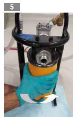
5 Visser la cartouche jusqu'à ce que le joint entre en contact avec la tête, puis tourner d'un demi-tour supplémentaire
