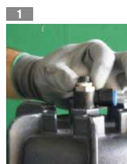
Desserrer l'écrou de purge d'air
