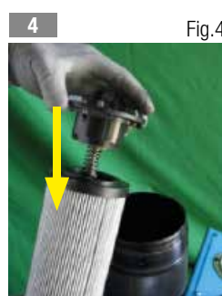
Insérer la coupelle bypass (fig. 4) ou la coupelle borgne (fig. 5) dans l'élément filtrant
