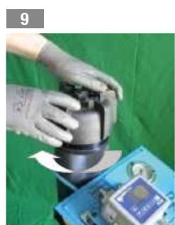
6 S'assurer que la cuve est bien serrée
