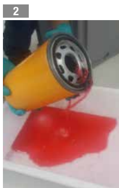
2 Recueillir l'huile contenue dans la cartouche dans un récipient adapté
