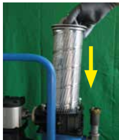
Insérer l'élément filtrant dans le filtre
