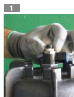
Desserrer l'écrou de purge d'air
