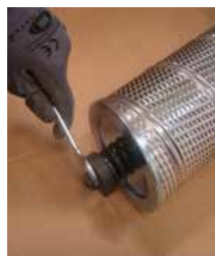
Serrer l'écrou jusqu'à la butée
