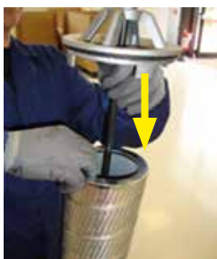
Installer un élément filtrant neuf
