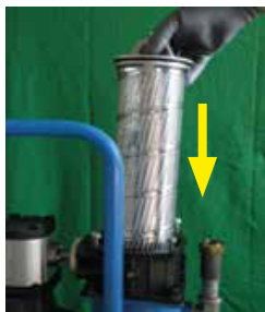
Insérer le support avec élément filtrant
