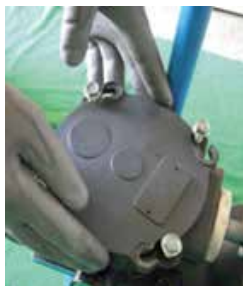
Ouvrir le couvercle du filtre
