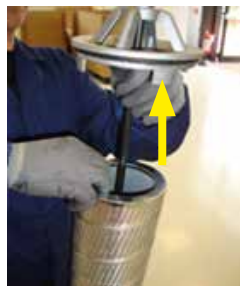
Enlever le support de l'élément filtrant
