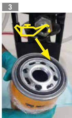
3 Lubrifier le joint de la cartouche avec le fluide de service
