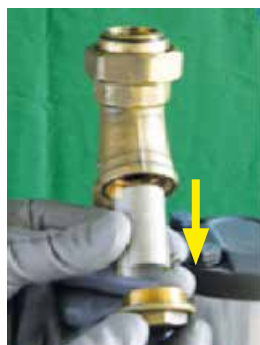
Dévisser l'écrou et retirer l'élément filtrant
