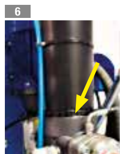
2 Vidanger l'huile via la vanne de vidange
