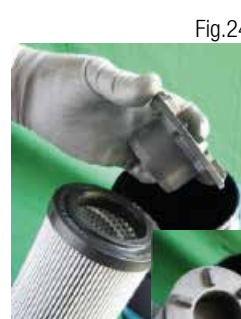
Insérer le capuchon à dérivation (fig. 23) ou le capuchon borgne éventuel (fig. 24) dans le nouvel élément filtrant
