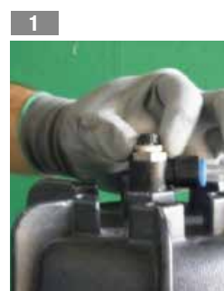
Ouvrir la soupape de purge
