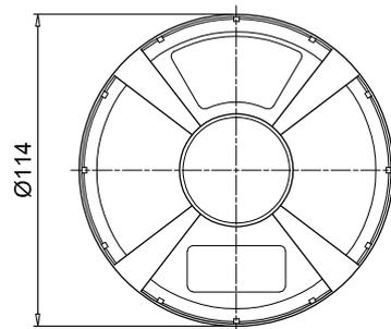
Perçage sur le réservoir
