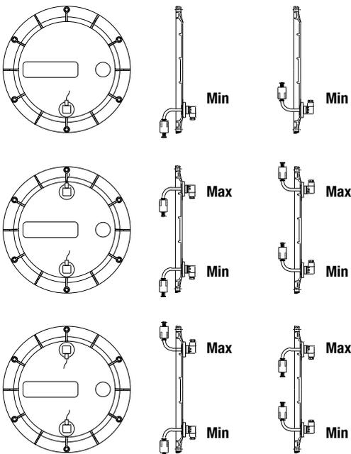
Disposition des trous de fixation de l'indicateur de niveau LEG
