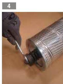
4 Serrer l'écrou jusqu'à la butée
