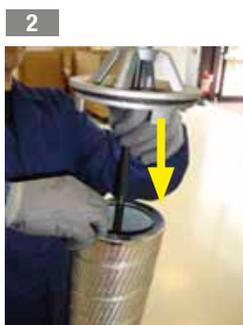
2 Insérer le support dans l'élément filtrant
