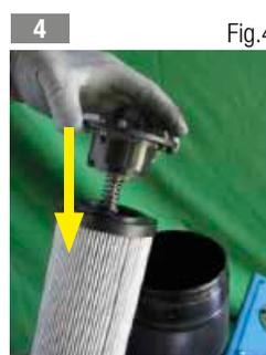
4 Insérer la coupelle bypass (fig. 4) ou la coupelle borgne (fig. 5) dans l'élément filtrant
