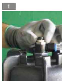
Desserrer l'écrou de purge d'air
