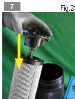
7 Insérer le capuchon à dérivation (fig. 23) ou le capuchon borgne éventuel (fig. 24) dans le nouvel élément filtrant
