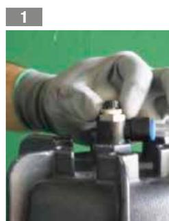
Desserrer l'écrou de purge d'air
