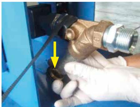
Dévisser l'écrou et retirer l'élément filtrant
