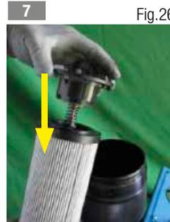
7 Insérer la coupelle bypass (fig. 26) ou la coupelle borgne (fig. 27) dans le nouvel élément filtrant Fig.26
