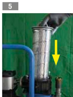
5 Insérer l'élément filtrant dans le filtre
