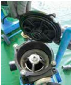
Vérifier le positionnement correct de l'élément filtrant
