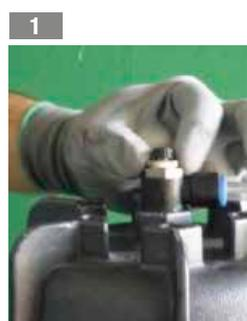
Desserrer l'écrou de purge d'air
