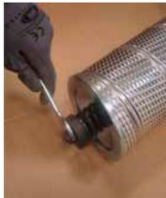
Serrer l'écrou jusqu'à la butée
