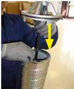
Installer un élément filtrant neuf
