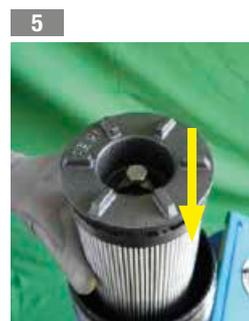
5 Insérer l'élément filtrant dans le corps du filtre
