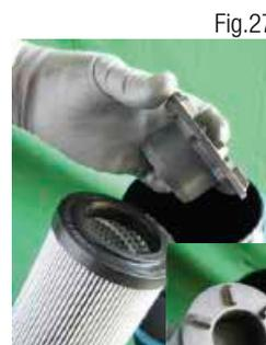
7 Insérer la coupelle bypass (fig. 26) ou la coupelle borgne (fig. 27) dans le nouvel élément filtrant Fig.27
