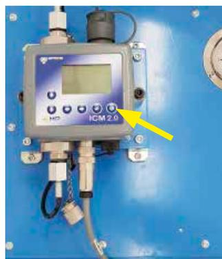
Bouton de démarrage d'une séquence de test
