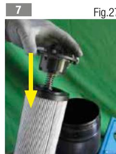
Insérer la coupelle bypass (fig. 27) ou la coupelle borgne (fig. 28) dans le nouvel élément filtrant
