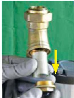
Dévisser l'écrou et retirer l'élément filtrant
