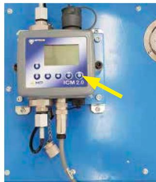
Bouton de démarrage d'une séquence de test Fig.15
