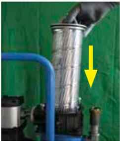
Insérer le support avec élément filtrant
