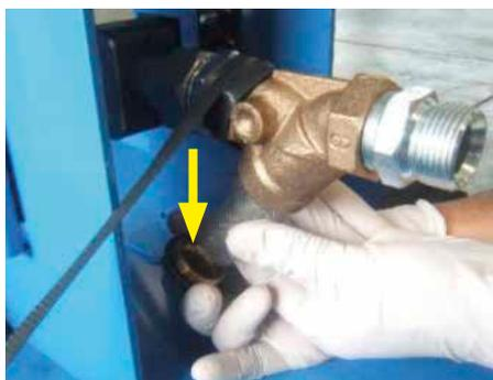
Dévisser l'écrou et retirer l'élément filtrant
