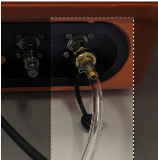
**Étape 2 :** Raccorder d'abord le tuyau sur l'entrée haute pression du CML4 puis sur le point d'échantillonnage haute pression sur le circuit.
