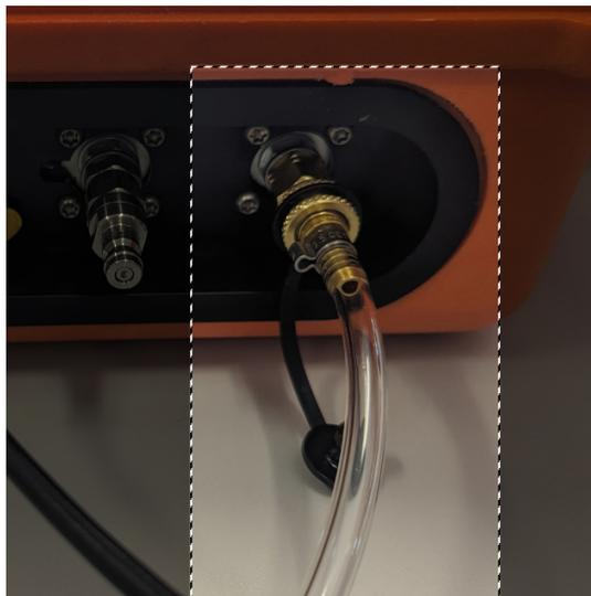
**Étape 2 :** Raccorder le tuyau d'aspiration sur le raccord rapide de l'entrée basse pression du CML4
