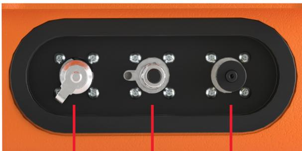
Point d'échantillonnage M16 x2 en mode système sous pression (en ligne)(haute pression)
