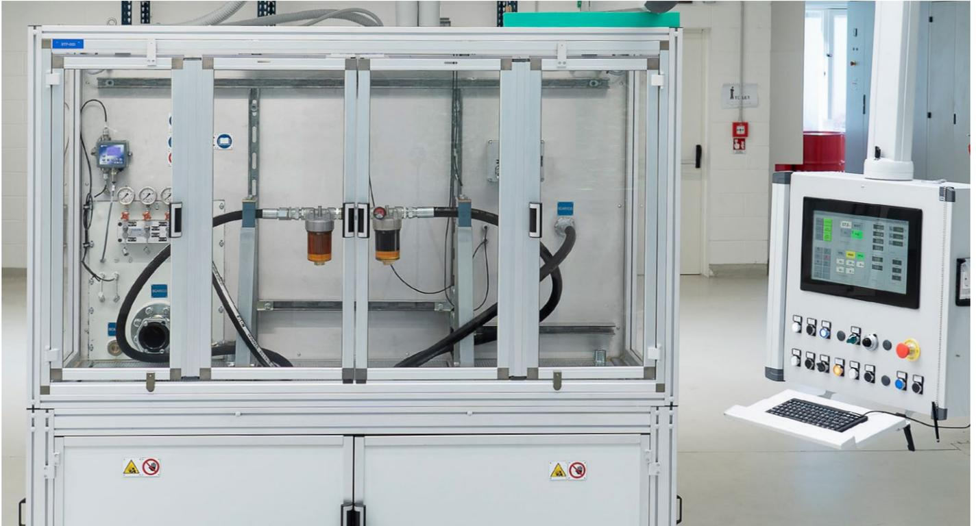
Le système hydraulique spécifique et les instruments de mesure utilisés sont capables de mesurer et d'enregistrer le potentiel électrique généré quand un débit d'huile traverse un filtre. Le potentiel est mesuré en kV.
