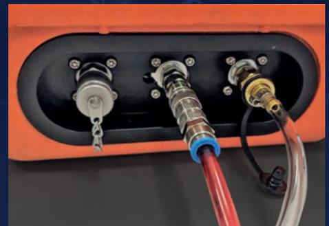
Connexion d'aspiration et sortie d'évacuation branchées
