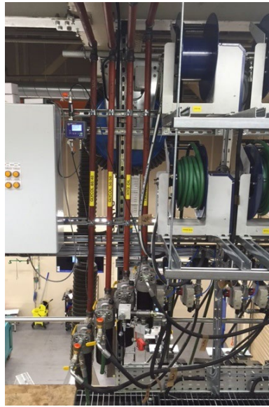
Flexible sur enrouleur avec compteur ICM intégré pour distribution de fluide
