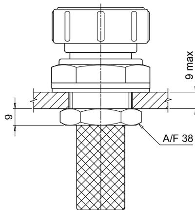
Orifice traversant sur le réservoir
