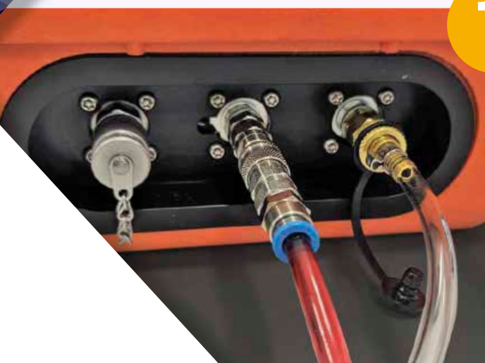
Connexion d'aspiration et sortie d'évacuation branchées
